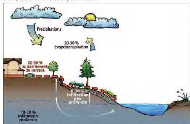
Figure 4 : Impacts de l'imperméabilisation des sols sur l'hydrographie naturelle d'un quartier de faible à moyenne densité.
